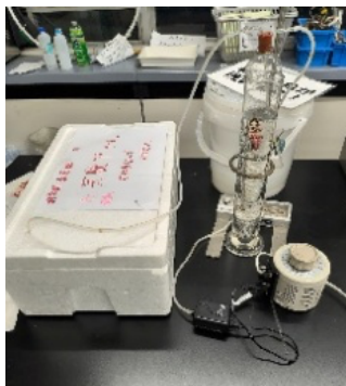
図2. 温度を一定にするための装置
