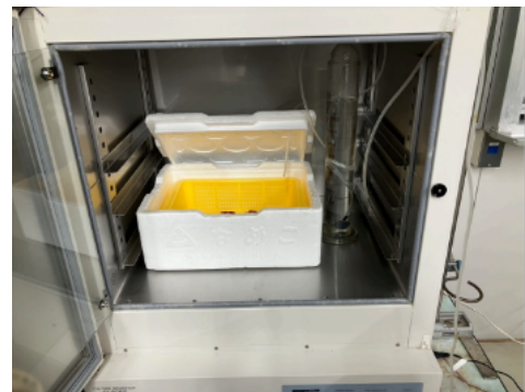
図4. 図1の装置を入れた保温槽
