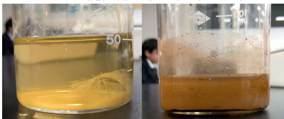
Figure 2 左:析出した結晶 7 右:分離せずに臭素化した際の溶液
