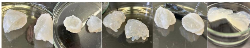
図3 浸漬1時間後のこんにゃく（左からメタノール、エタノール、グリセリン、アセトン、熱湯）
