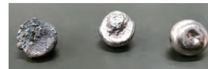
図 3. 方法②で得られた青銅 (左から順に、松炭の量 (d) 1.0 g、(e) 2.0 g、(f) 3.0 g)
