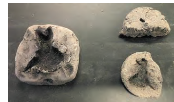
図 2. 方法③で使用した型 (左：道具土のみ(型 A) 右：砂型(型 B))
