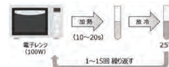
図 3 断続的繰り返し加熱の方法
