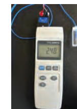
図4 石英セルとK熱電対温度計
