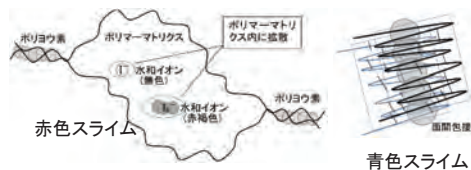
Fig. 2 スライム状ヨウ素電解液の色別構造イメージ 左: 赤色 (柔らかいスライム状) 右: 青色 (硬いゲル状)
