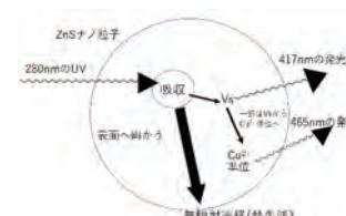
図7. 吸着剤を添加していない ZnS ナノ粒子の模式図
